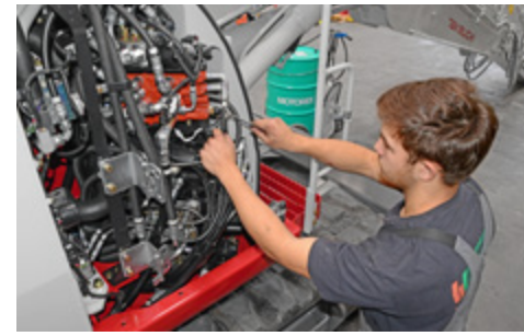
Die Ventilbank dieses Takeuchi-Kompaktbaggers steuert sämtliche Hydraulikfunktionen.
